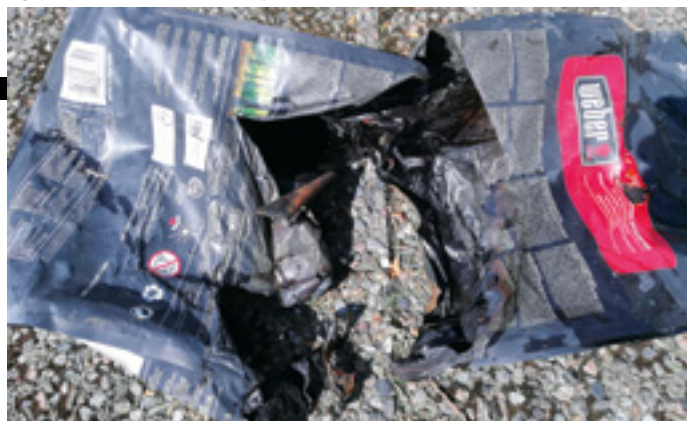
Foto: Knut Vik Sollyset forårsaket så mye varme at posen med grillbriketter fra Weber selvantente.
