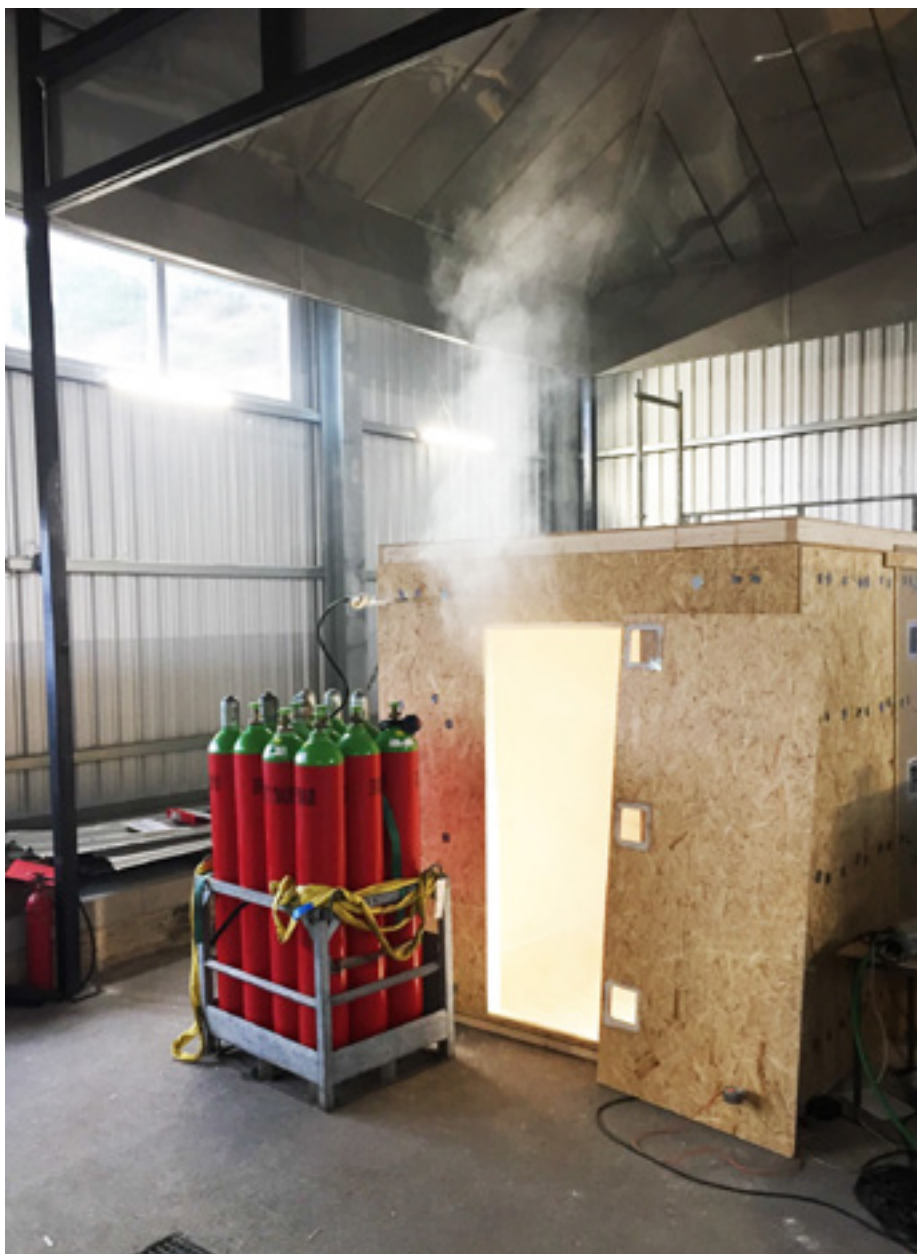
En bacheloroppgave har sett på om Inergen vil ha en sløkkeeffekt i hulrom i bygninger.
